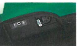
accensione e connessione carica batterie, sull lato dello zaino
